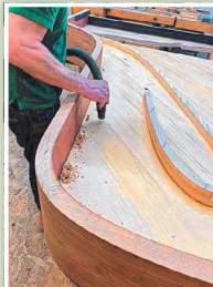
Der Resonanzboden aus Fichte ist bereits wieder eingebaut.
